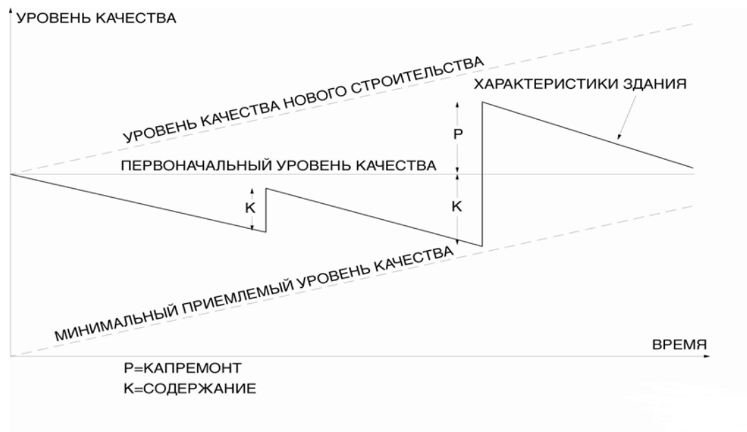
Рис. 3. Динамика изменения технического состояния здания и влияние на этот процесс мероприятий по ремонту и реконструкции.
