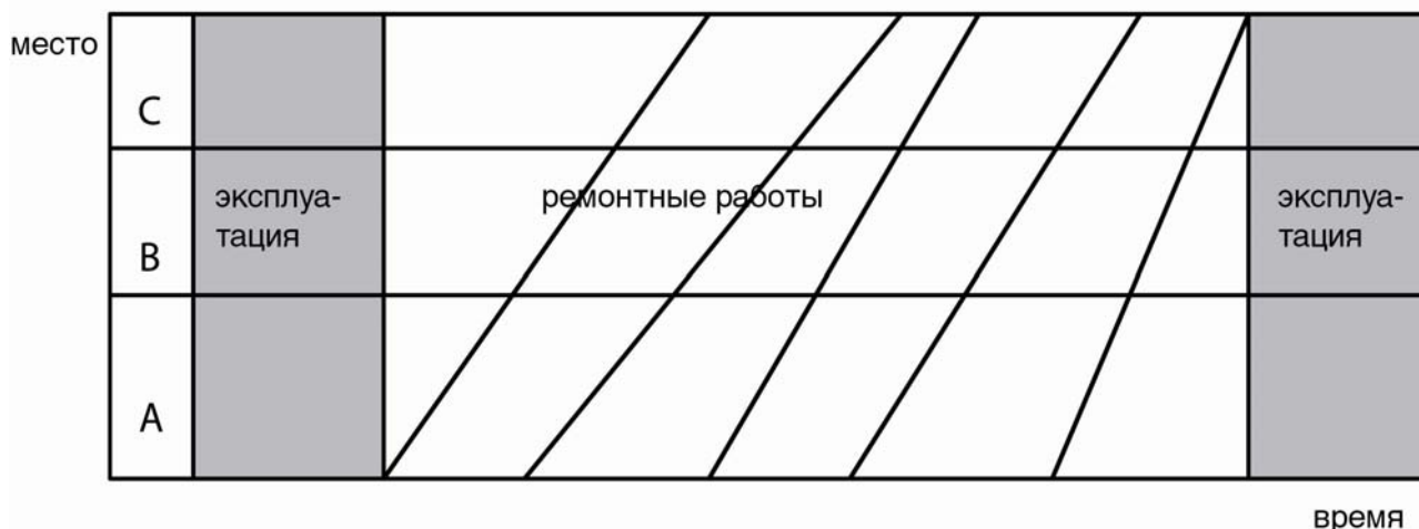
Рис. . График эксплуатации и производства работ на объекте, требующего полностью ремонта помещений.
