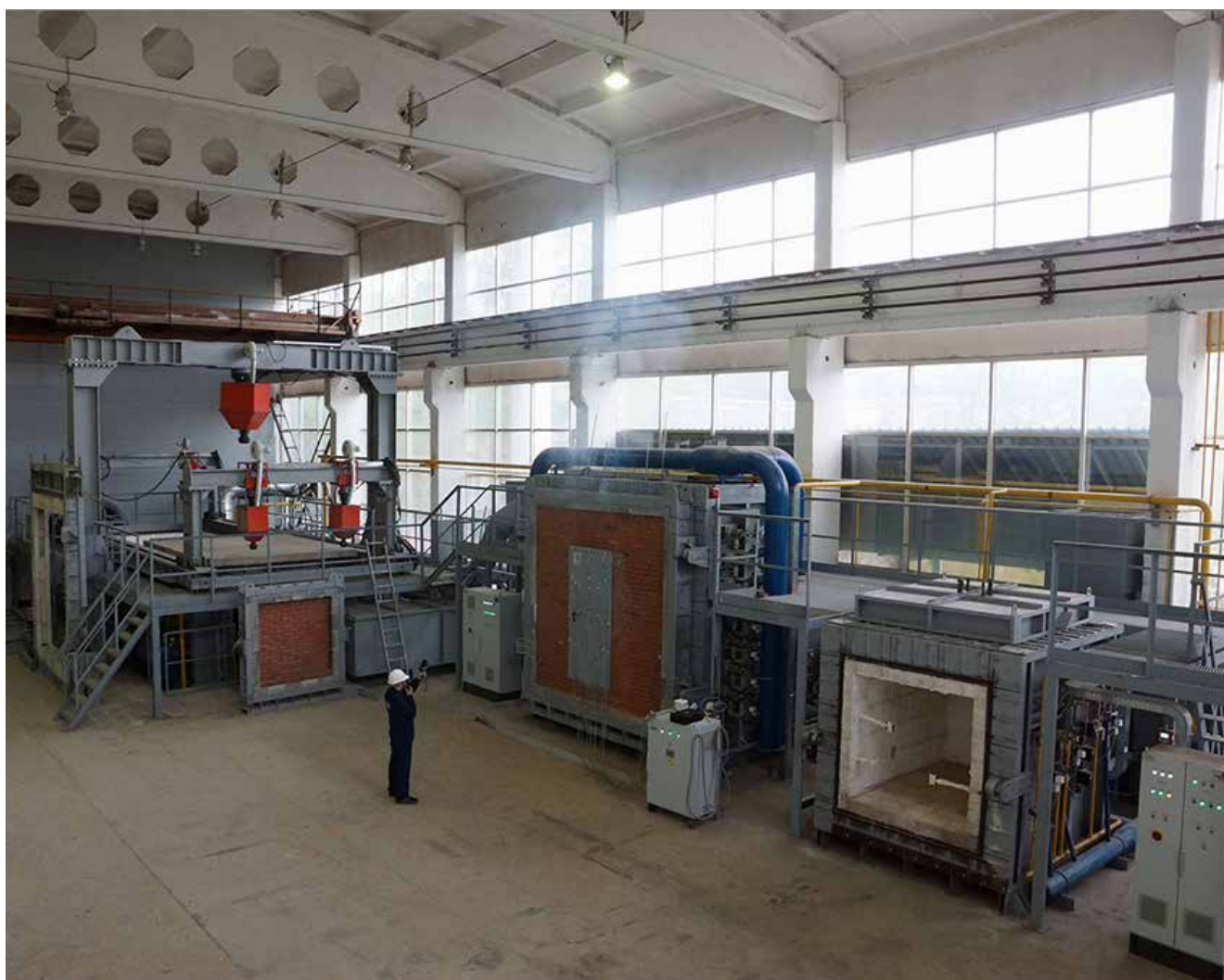
Испытательный комплекс для определения огнестойкости строительных конструкций
