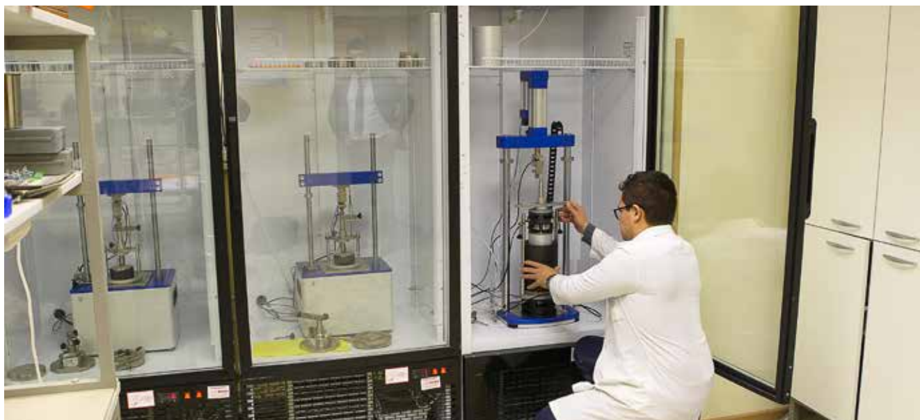
Комплект оборудования для испытаний образцов грунта в условиях трехосного сжатия вертикальной нагрузкой
