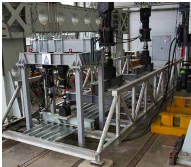
Испытания мостовых конструкций из алюминиевых сплавов
