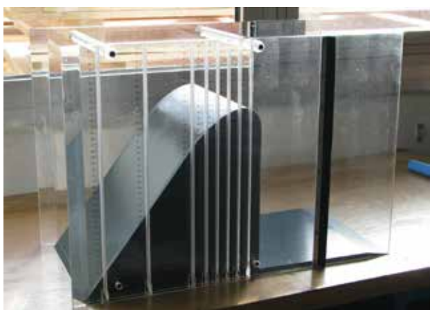
Водослив практического профиля
