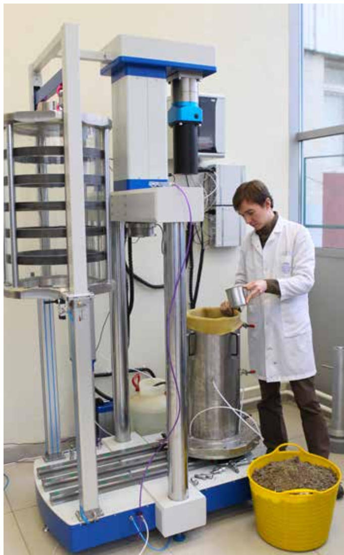
Автоматизированный испытательный комплекс «АСИС» для испытаний крупнообломочных грунтов в условиях трехосного сжатия
