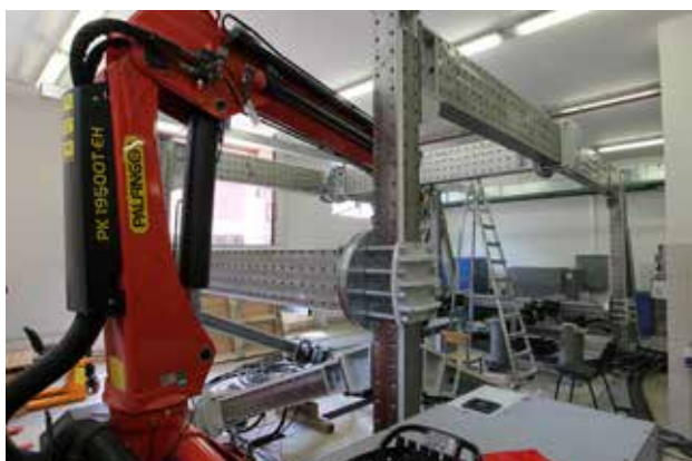
Реконфигурируемый стенд для испытаний строительных конструкций (1500 кН)
