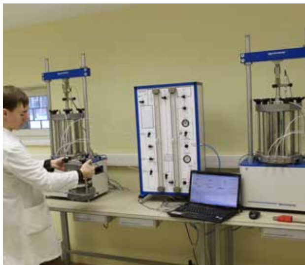
Стабилметры – установки для проведения трехосных испытаний грунтов (тип А)
