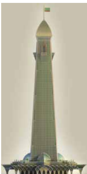
«Башня Ахмат» высотой 400 метров, проектируемая на площадке с интенсивностью землетрясения 9 баллов по шкале MSK-64.
