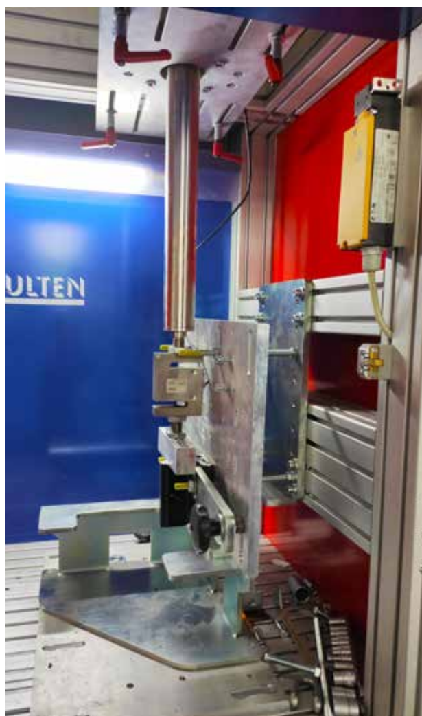
Стенд для испытания угловых соединений
